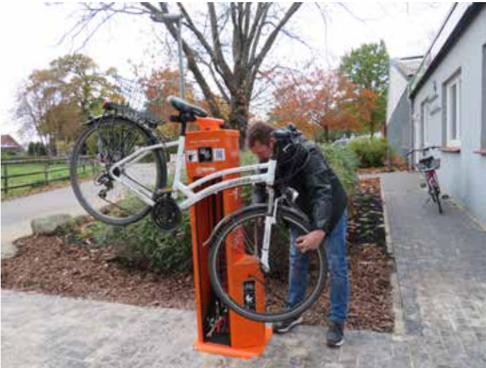
Die neue Fahrradservice-Station mit Reparaturanleitungen, Werkzeug und Luftpumpe.
